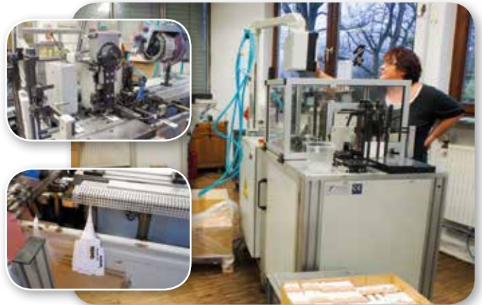
Das Etikett wird auf speziellen Anlagen mit Gummifäden oder Draht maschinell verarbeitet.
